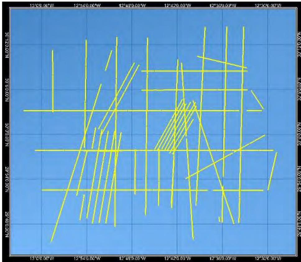
Figura 3.2. Líneas de navegación realizadas para el levantamiento batimétrico con ecosonda multihaz en el techo del Banco de La Concepción.
