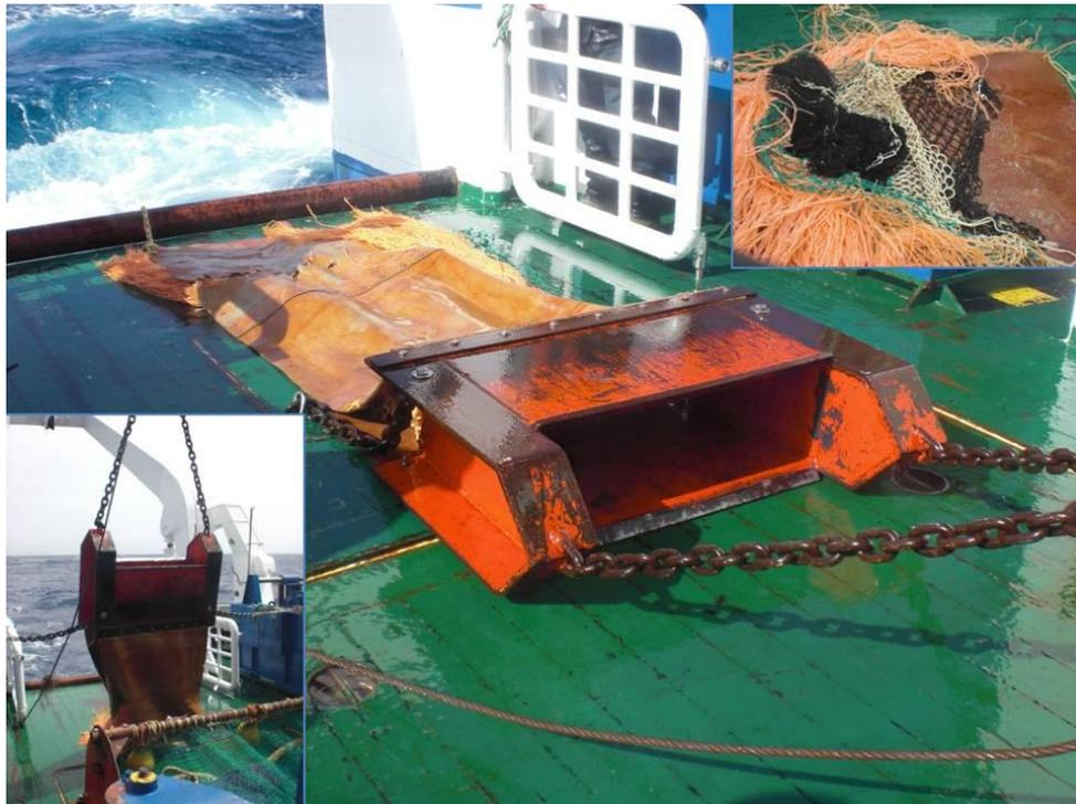
**Figura 6.** Draga de roca en cubierta y detalles de sus partes y las maniobras con ella.
