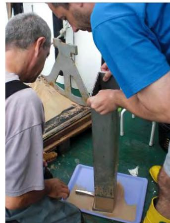
Figura 4.6.1. Draga Mega Box Corer: maniobra de virado y muestras resultantes.
