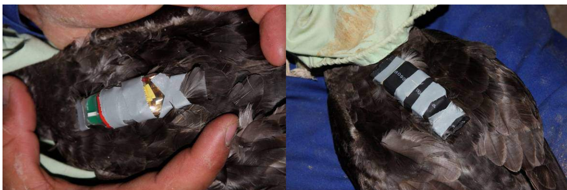
Figura 3. Registradores GPS de la firma Technosmart (izquierda) y de la firma Cat@track (derecha) recubierto con goma termoretráctil colocado en pardela balear. Foto: B. Rodríguez.
