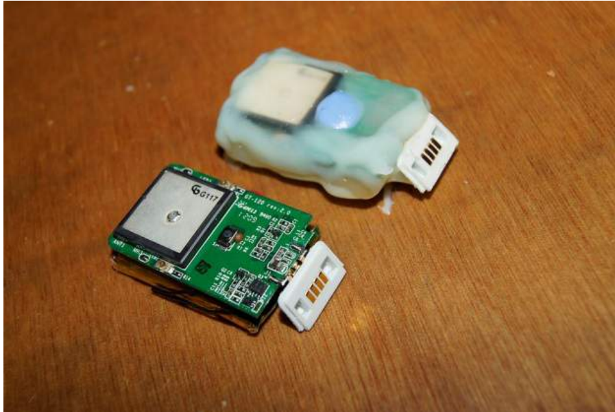
Figura 3. GPS sin carcasa plástica original (izquierda) y encapsulado en Epoxi (derecha). Imagen: Robert Manzano.
