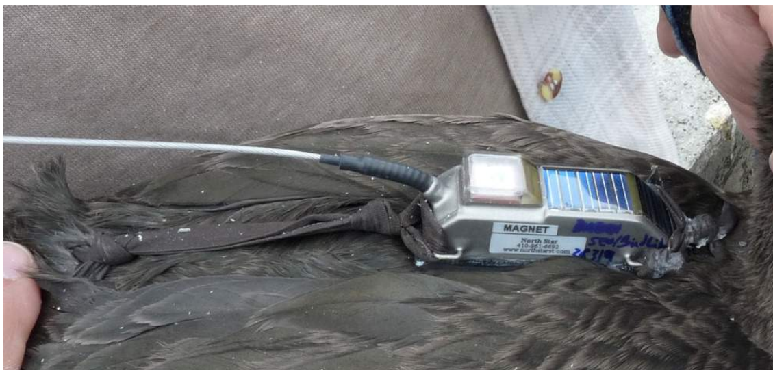
Figura 3. Detalle de uno de los emisores GPS-PTT usados para el marcaje de cormorán moñudo mediterráneo Phalacrocorax aristotelis desmarestii , colocado ya en uno de los ejemplares marcados. Se puede apreciar la antena del GPS (parte superior izquierda) y las placas de alimentación solar, así como el enganche con el arnés. Foto: J. Prieto.
