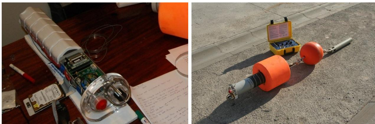
Figura 2.2.10 – El sistema EAR está constituido por un microprocesador y un convertidor analógico-digital, que graba los sonidos detectados y almacena las grabaciones en un disco duro. La programación de las grabaciones se efectúa de dos formas distintas: a través de un horario regulado, que graba y se detiene según se programe, o a través de un disparo automático, que se activa al inicio de una detección de un barco o de un cetáceo.
