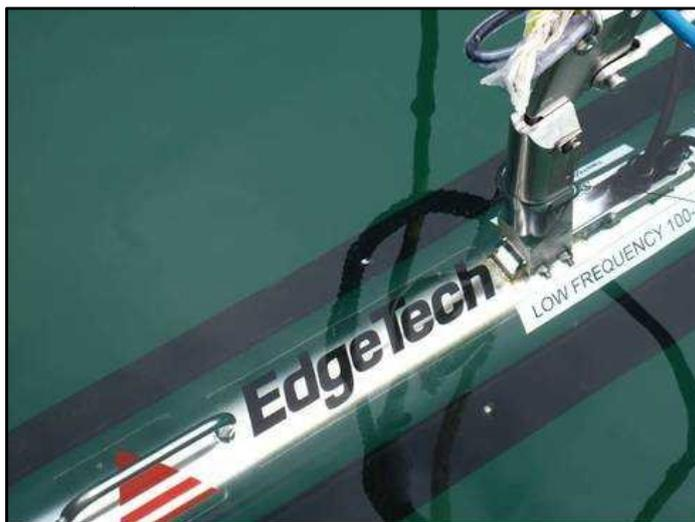
Figura 3.2.11 – Towfish Edgetech de baja frecuencia. Se destaca que este sonar, incluso en su configuración de baja frecuencia, alcanza una resolución aceptable para cartografiar blancos de pequeño tamaño, aunque más fácilmente cuando el patrón de distribución es repetitivo (rocas, vegetación) y cuando no existen falsos blancos en las inmediaciones (Foto: Ecohydros).
