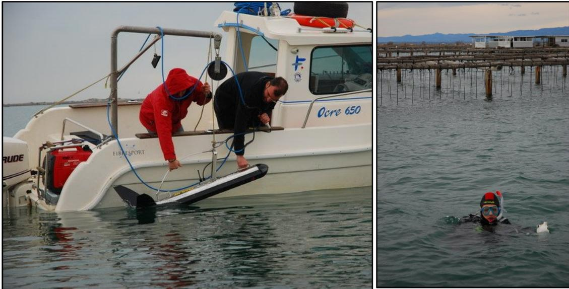
Figs. 3.2.17 y 3.2.18 – Colocación del Towfish Edgetech en el agua para comenzar con el sondeo (izq.) y buceador listo para una inmersión de verificación junto a la boya marcando la posición del indicio (dcha.).
