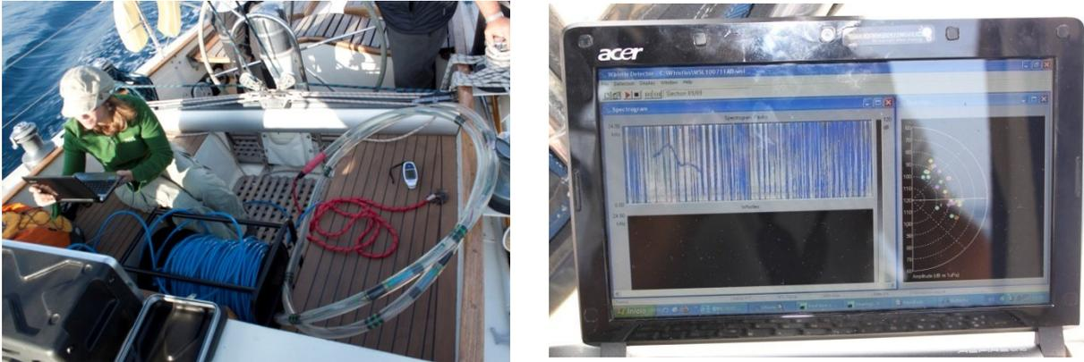
Figura 2.2.3 – Equipo de a bordo para la detección a través de acústica, formado por un hidrófono bicanal, una bobina de cable keblar de 200 m, una caja con la interfaz y un ordenador portátil, equipado con un software especializado.
