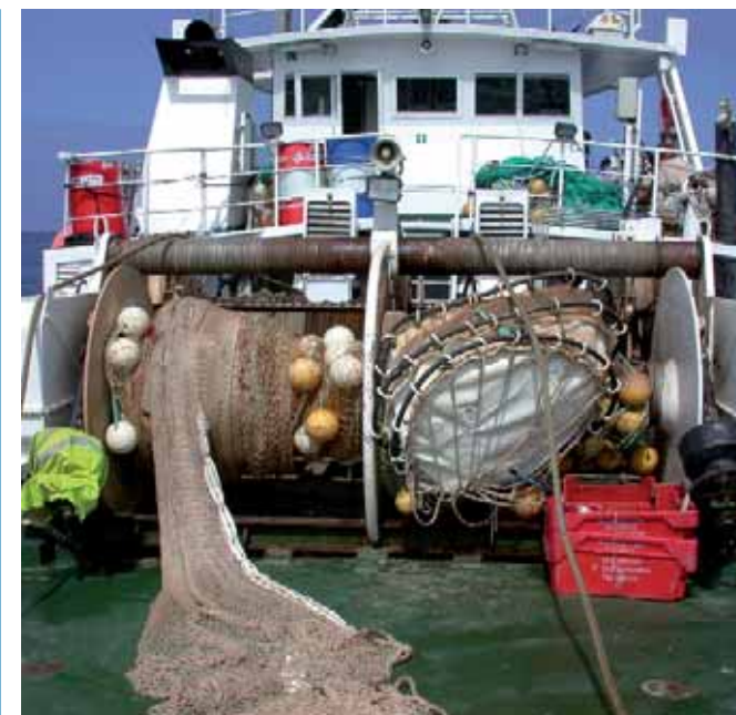
Vista del arte, copo piscina, utilizado para la pesca de merluza en las experiencias de marcado.
